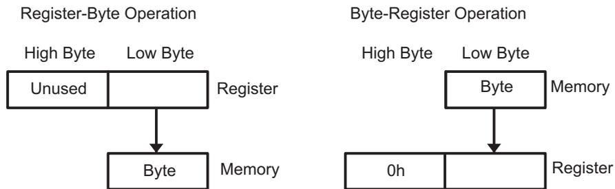
Figure 3-7. Register-Byte/Byte-Register Operations
