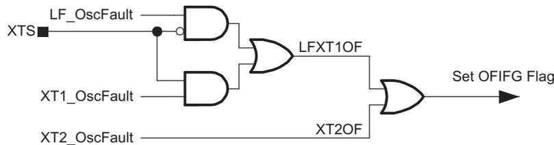
**Figure 5-8. Oscillator-Fault Logic**
