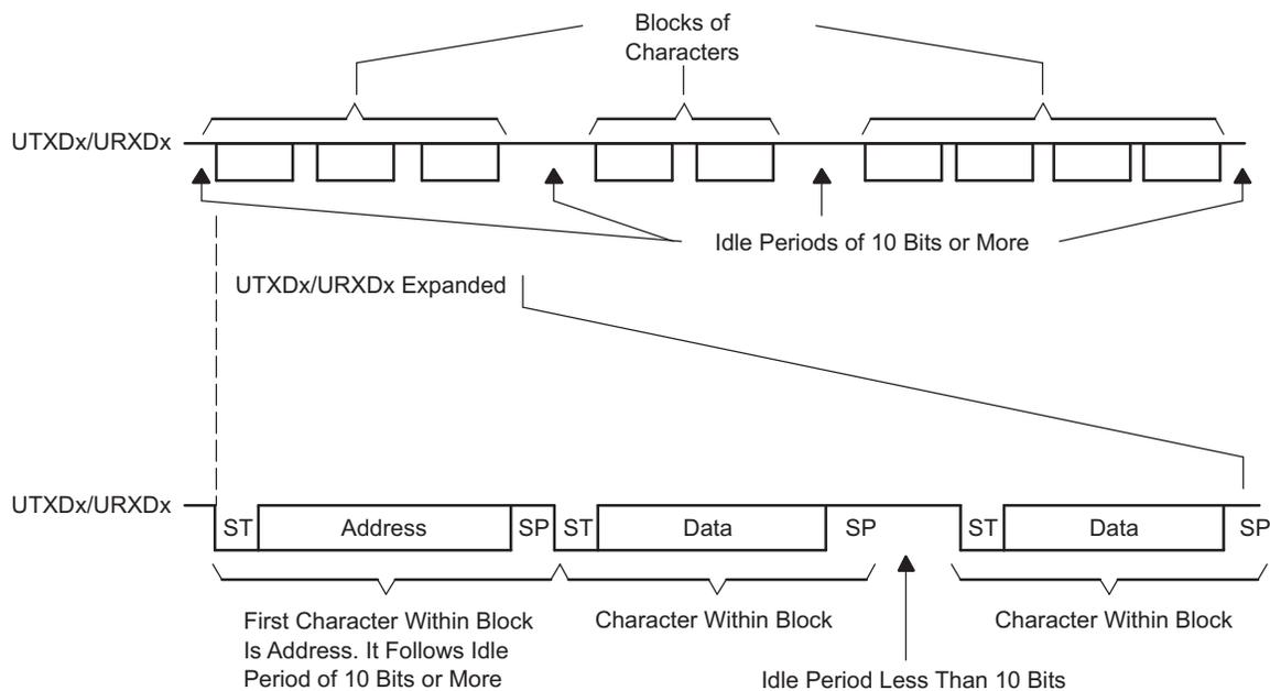
**Figure 18-3. Idle-Line Format**
