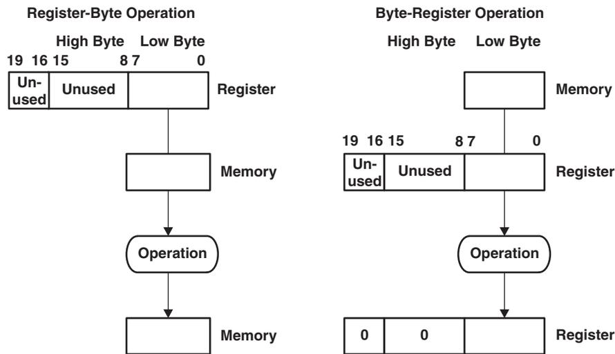
Figure 4-10. Register-Byte/Byte-Register Operation
