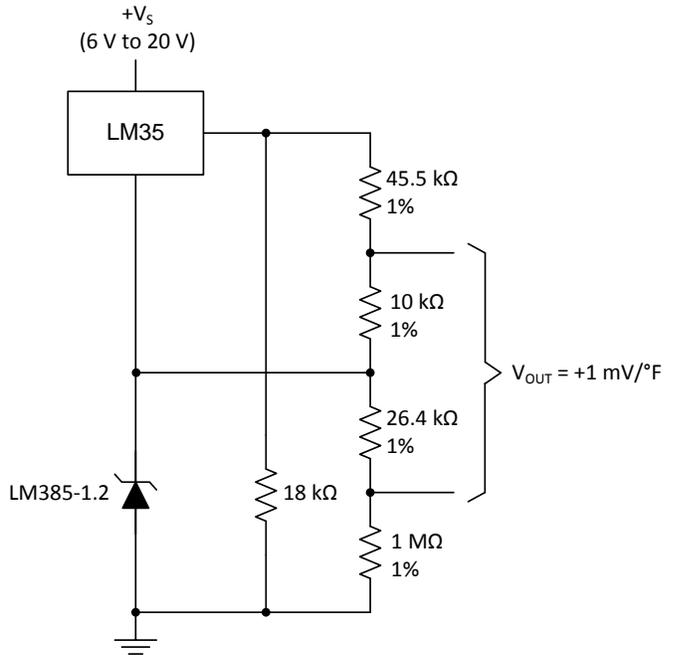
Figure 21. Fahrenheit Thermometer
